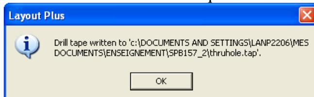
Le fichier NCDrill nommé par défaut ici thruhole.tap est un fichier de texte contenant la description des outils de perçage dont leur diamètre, et la position selon les axes X et Y de chacun des trous à percer sur la carte.
