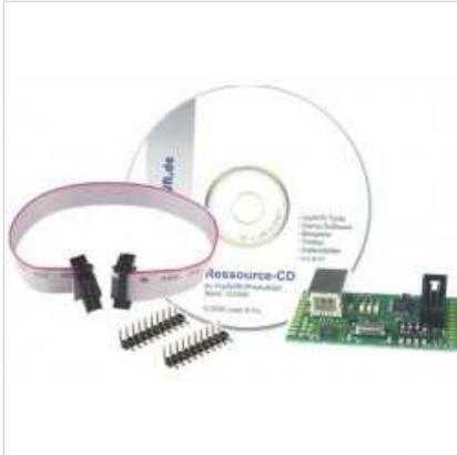
Programmateur USB in-situ compact pour microcontrôleurs AVR. Configurable, il peut également servir de pont USB vers UART, SPI ou TWI.
