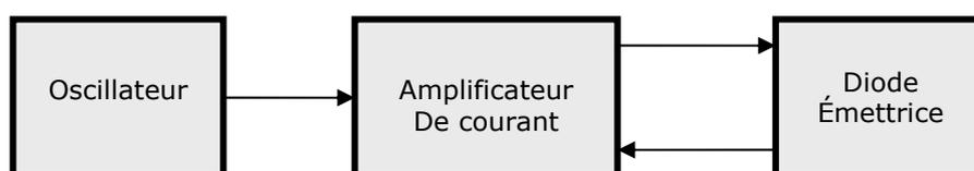
**Figure 1** Schéma bloc du montage émetteur.
