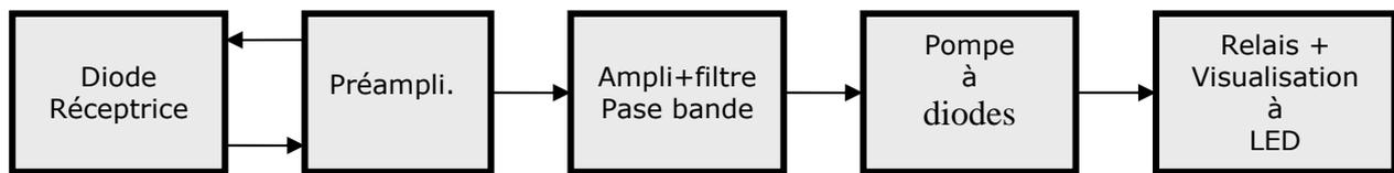
Figure 2 Schéma bloc du montage récepteur.
