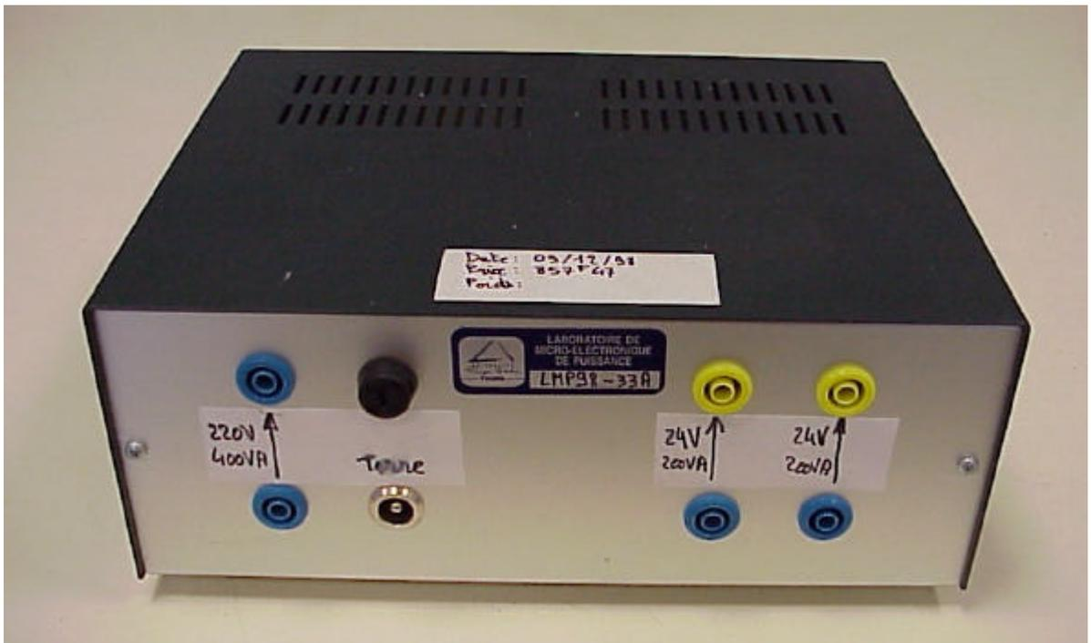
Figure 6.1. Transformateur torique 230V - 2x24V - 400VA (images-maquettes\tr400va.jpg).
