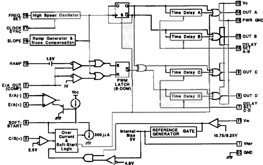
Fig 14. - UC3875 Block Diagram
