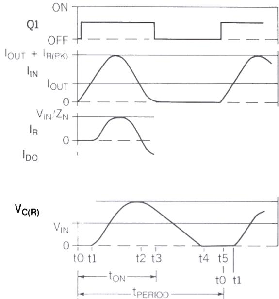
Fig. 2 - Quasi-Resonant Waveforms
