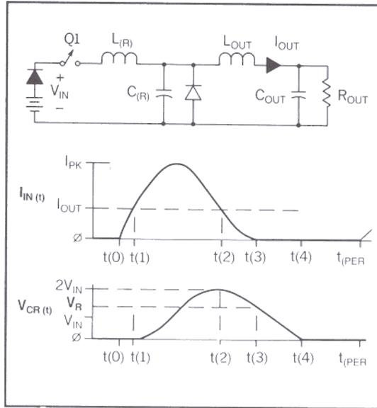
Fig. A4, A5 - Quasi-Resonant Buck Converter
