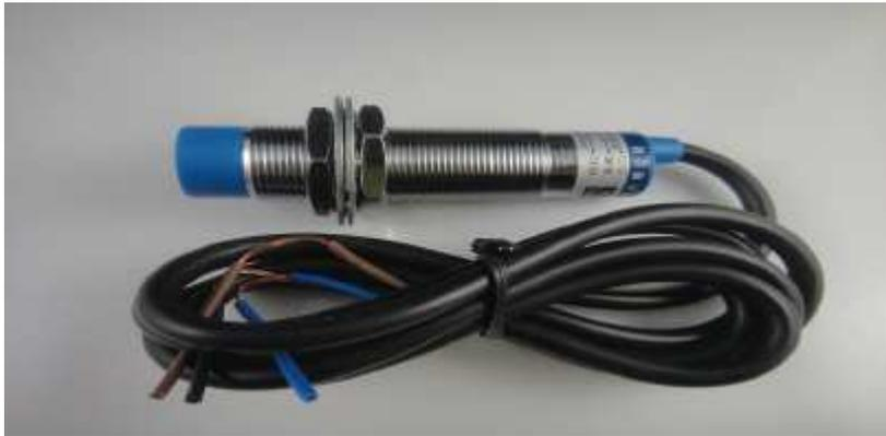
**Figure 17 - Capteur de vitesse**
