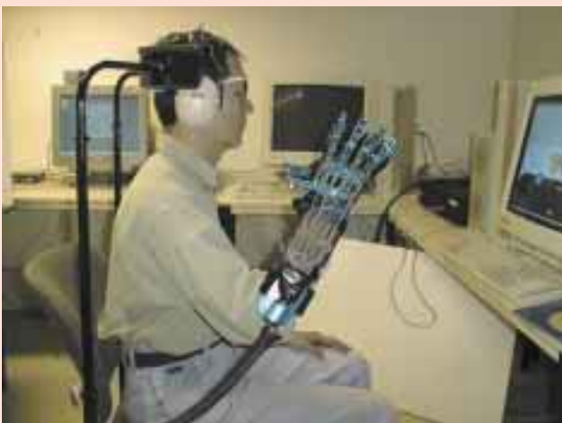
Sujet équipé du gant à retour d'effort (LRP Force Feedback Glove) lors d'une tâche impliquant la saisie et le positionnement précis d'objets virtuels rigides (Photo Laboratoire de Robotique de Paris).
