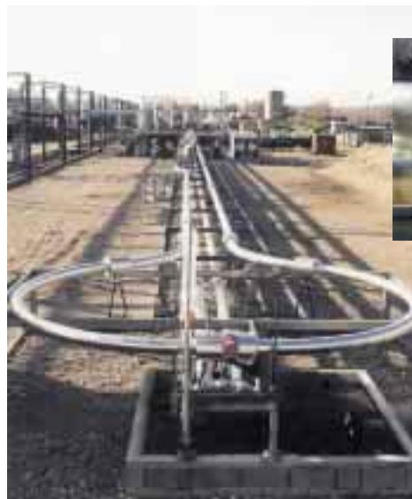
La boucle polyphasique Lyre qui a validé de nouveaux additifs dispersants pour éviter la création de cristaux d'hydrates de gaz (Photos IFP).
