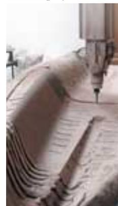
2,75 m a été fraisé en commande numérique à partir d'une couche de pâte SMP extrudée, en utilisant directement les données en format IGES du concepteur Paul Handley, pour un coût comparable à celui de la méthode manuelle.
