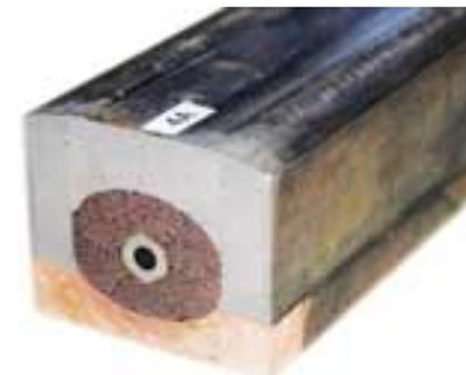
La compaction du conducteur sur la semelle en cuivre assure la continuité électrique (Photo CEA).
