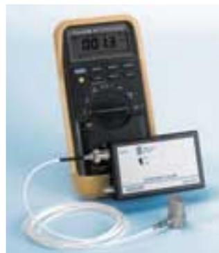
excellente solution pour contrôler *in situ* le niveau de vibration émis par les machines tournantes. Le dispositif s'assure automatiquement de l'intégrité de la chaîne de mesure et signale toute anomalie du circuit.
