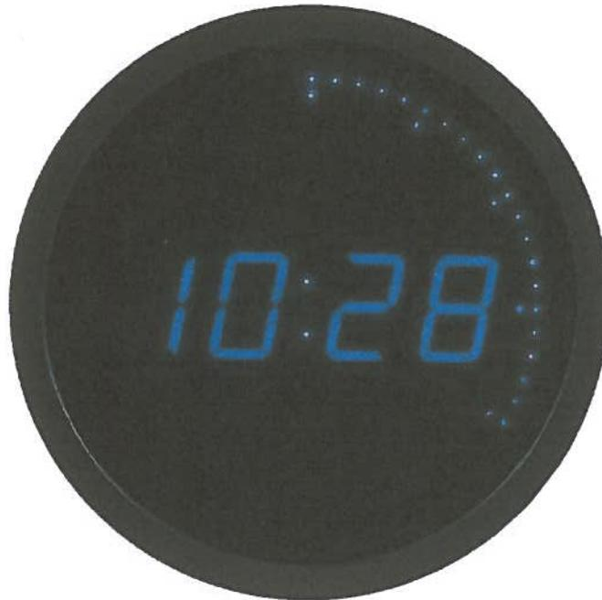
*Illustration 5: Horloge à 60 LED pouvant fonctionner avec des registres à décalages*
