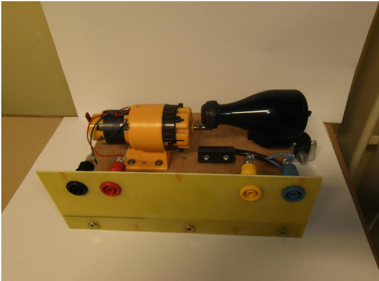
*Illustration 4 Maquette de test de la dynamo*
