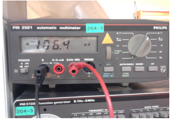
Illustration 12: Mesure du courant débitée par la batterie.
