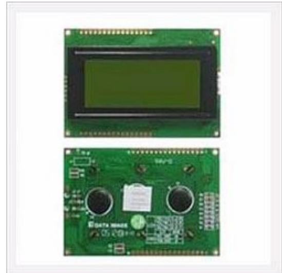
Pour notre projet comme énoncé dans le cahier des charges, nous utilisons pour afficher la température et la tension de chaque batterie, un LCD 16\*4 (quatre lignes, seize colonnes).
