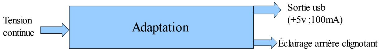
Le bloc optionnel va permettre à notre carte de se démarquer de celles présentes sur le marché. Il consiste à créer une tension constante, indépendamment de la charge et de la tension d'entrée .
