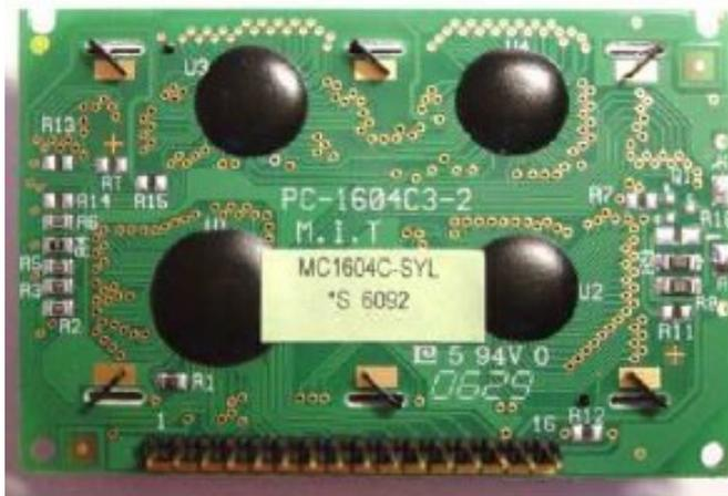
*Illustration 9: Circuit et connectique de l'afficheur*
