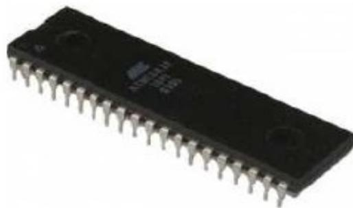
*Illustration 5: Vue du microcontrôleur Atmel Atmega 8535*
