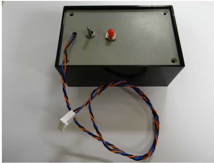
Illustration 29: Boîtier de test pour les capteurs
