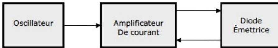
*Illustration 4: Schéma structurel de la partie émettrice*
