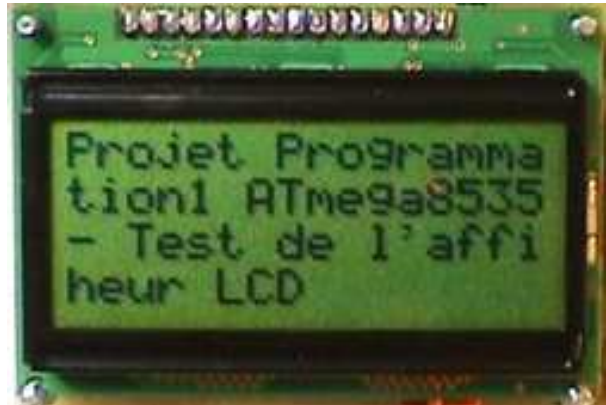
Illustration 24: exemple de test d'afficheur LCD valide [1]
