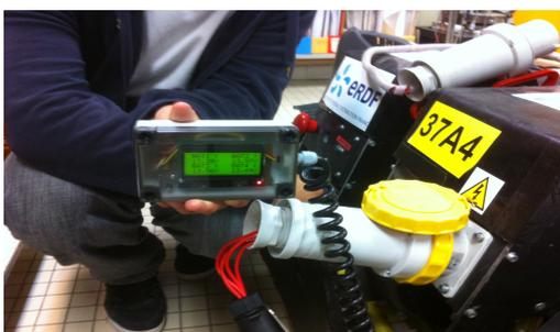
Enfin, après la conception du boîtier réalisée, on a testé le vu-mètre directement sur le kart. Les tests se sont montrés concluant et les erreurs de mesure de tensions étaient du même ordre que pendant les tests dans la salle.
