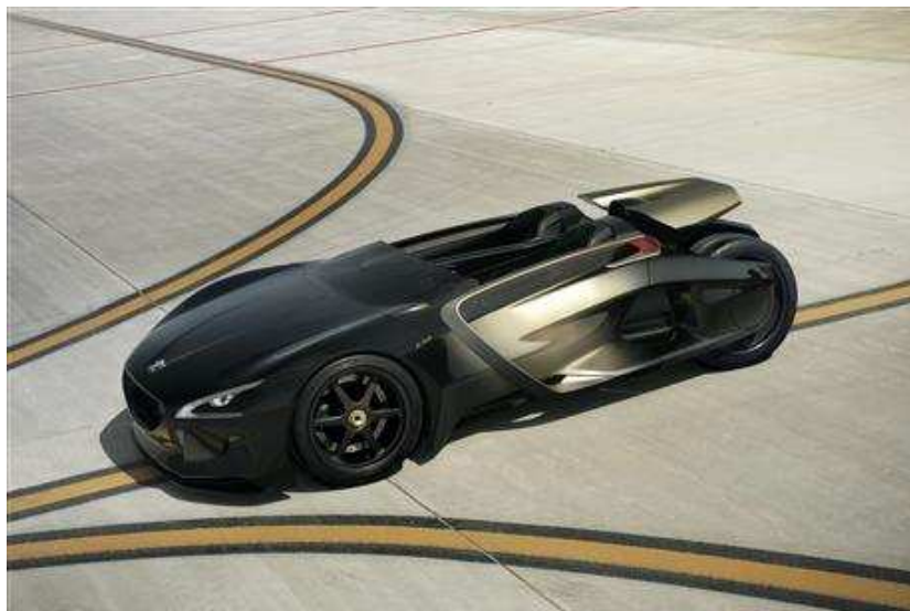
La Peugeot EX1, est un roadster biplace conçu autour de ses batteries lithium-ion, à peine plus long qu'une Peugeot 107
