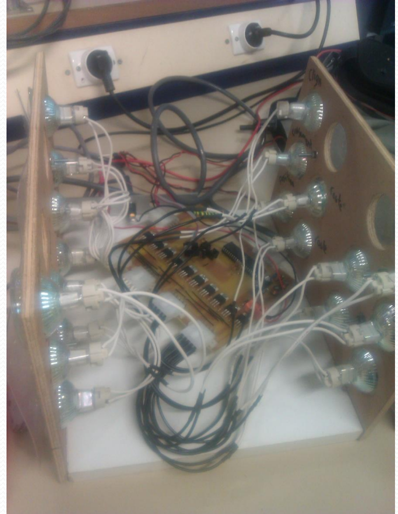
Maquette de simulation des phares du Kart
