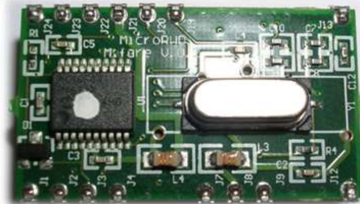
Module RFID et son antenne 13,56 MHz
