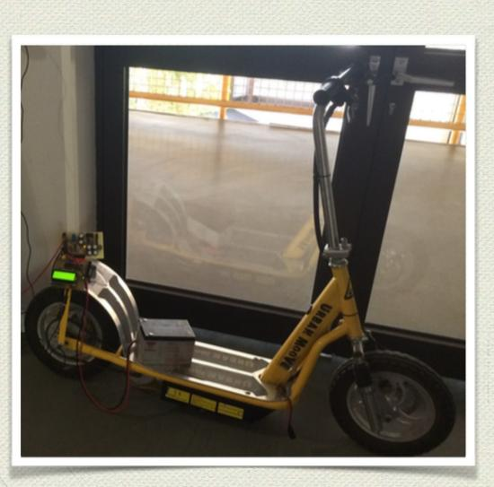
Réalisation d'un chargeur à partir d'un panneau solaire pour deux batteries de 12V
