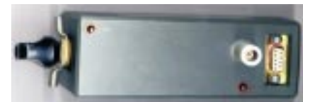
Fig. 5: shunt enfichable avec connecteur triaxial
