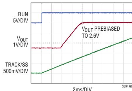
$V_{IN} = 12\text{V}$
