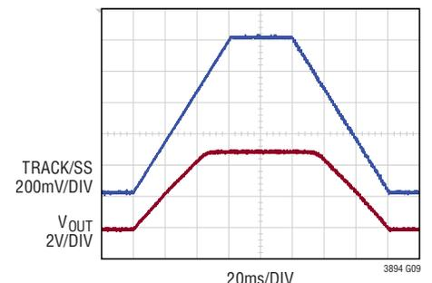
$V_{IN} = 12\text{V}$
