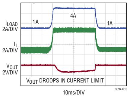
$V_{IN} = 12\text{V}$
