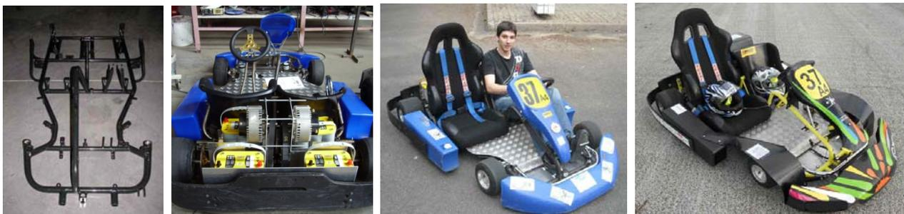
Fig. 3. Le kart électrique au fil des années – De droite à gauche : livraison du châssis en novembre 2006 / Montage à "blanc" des moteurs à courant continu en mars 2007 / Novembre 2011 installation du siège baquet pour le passager / Version de mai 2012 : protection des personnes, nouvelles motorisations synchrones et décorations.
