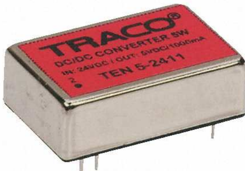
Figure 4.11. Convertisseur TRACO POWER (traco-ten-5.jpg).
