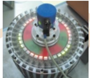
Issues des recherches menées au LEEI dans le domaine des machines silencieuses pour la propulsion navale, ce prototype à stator sans encoches modulaire permet de tester les différents modes d'interaction courant-aimantation utilisés dans les convertisseurs électromécaniques modernes. Un système électroluminescent intégré offre la possibilité de visualiser la distribution spatio-temporelle des sources du champ statorique.
