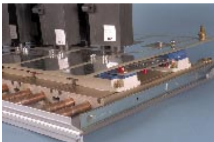
Un des premiers onduleurs multicellulaires réalisés au LEEI.
