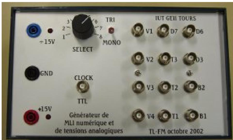
Fig. 2.5. Commande MLI (images-maquettes\mli8bits-62.jpg).
