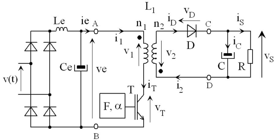
Fig. 8.1. Alimentation à découpage asymétrique de type FLYBACK
