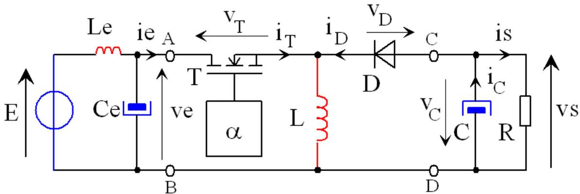
Fig. 4.1. Hacheur inverseur à stockage inductif (dessins\hinver0.drw).
