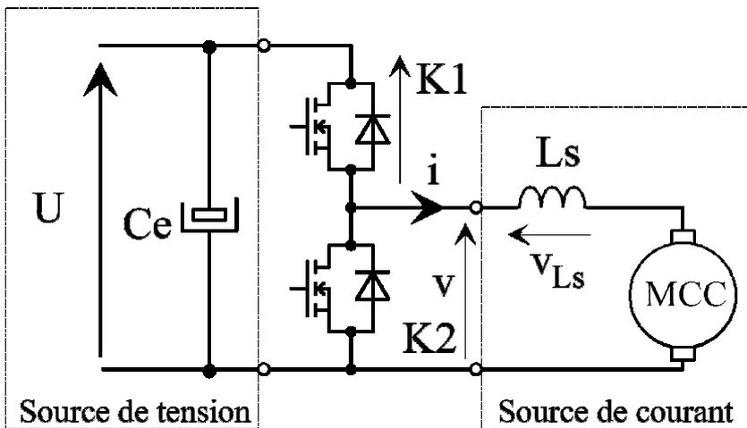
Fig. 6.1. Hacheur réversible en courant « 2 QUADRANTS » (dessins\hacheur6.drw).
