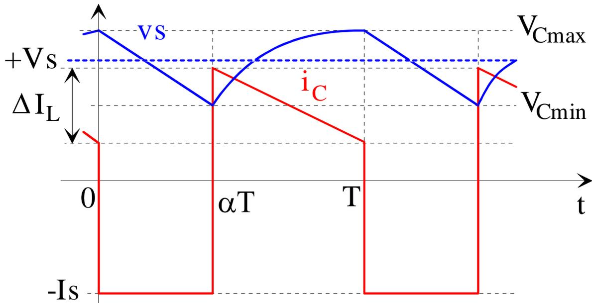
$$\text{Pour } t \in [0 ; \alpha T] : v_C(t) = \frac{1}{C} \int i_C(t) \cdot dt = V_{Cmax} - \frac{I_S}{C}(t - 0)$$
