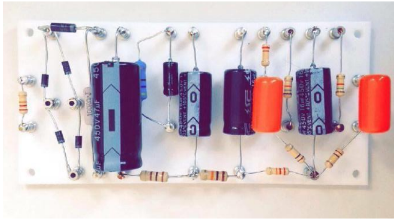
Figure 21 : La "Turret Board" avec les éléments passifs (dont le pont de diodes)
