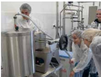
Cette ligne, destinée, dans un premier temps, aux Travaux pratiques, est constituée de broyeurs couteaux, dénoyauteuse, raffineuse, pressoir hydraulique, cuve à enzymation, filtre à plaques, pasteurisateur électrique triétrage, embouteilleuse et capsuleuse.
