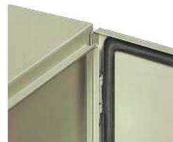
Porte pleine à ouverture 120°, livrée avec poignée, joint polyuréthane et profil en forme de gouttière, assurant une parfaite étanchéité.
