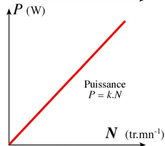
Machine à couple proportionnel à la vitesse (pompe volumétrique, mélangeur)
