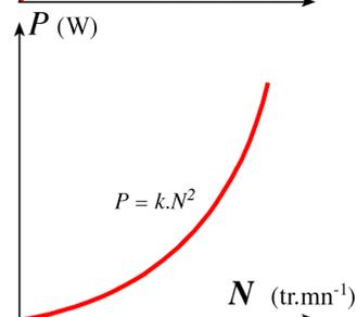
Machine à couple proportionnel au carré de la vitesse (ventilateur)
