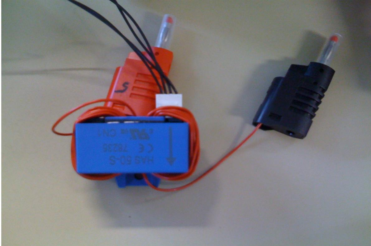
Pour simuler la mesure de courant avec des intensités importantes, on effectue un bobinage pour que le capteur « voit » un champ plus important.
