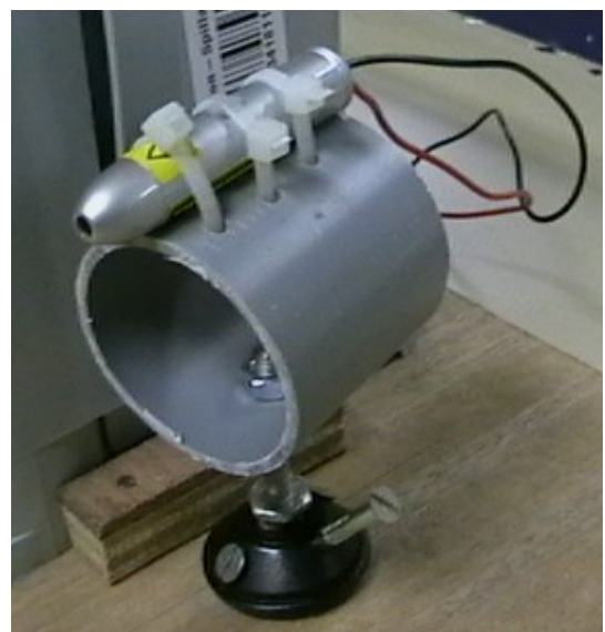
Illustration 10: Montage complet du pointeur laser
