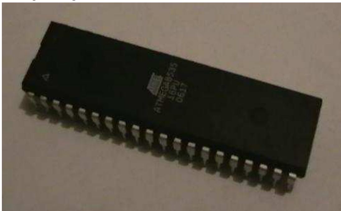
Illustration 5: Photo du micro-contrôleur ATmega 8535
