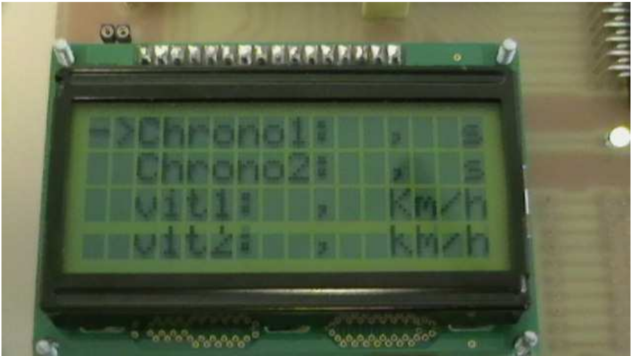
Illustration 21: Photo de l'affichage de l'écran LCD après la mise sous tension
