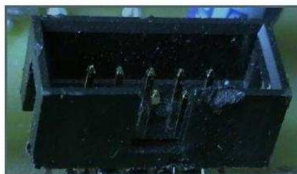
Illustration 8: Photo du connecteur ISP
