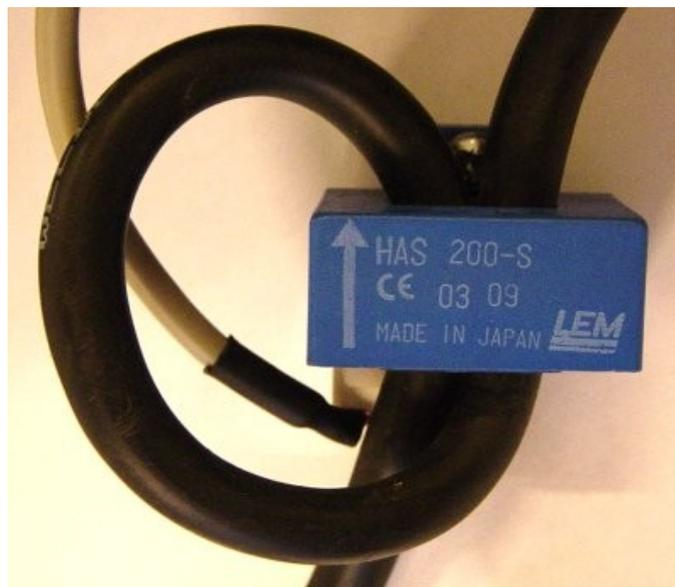
*fig 5. capteur de courant HAS200-S*
