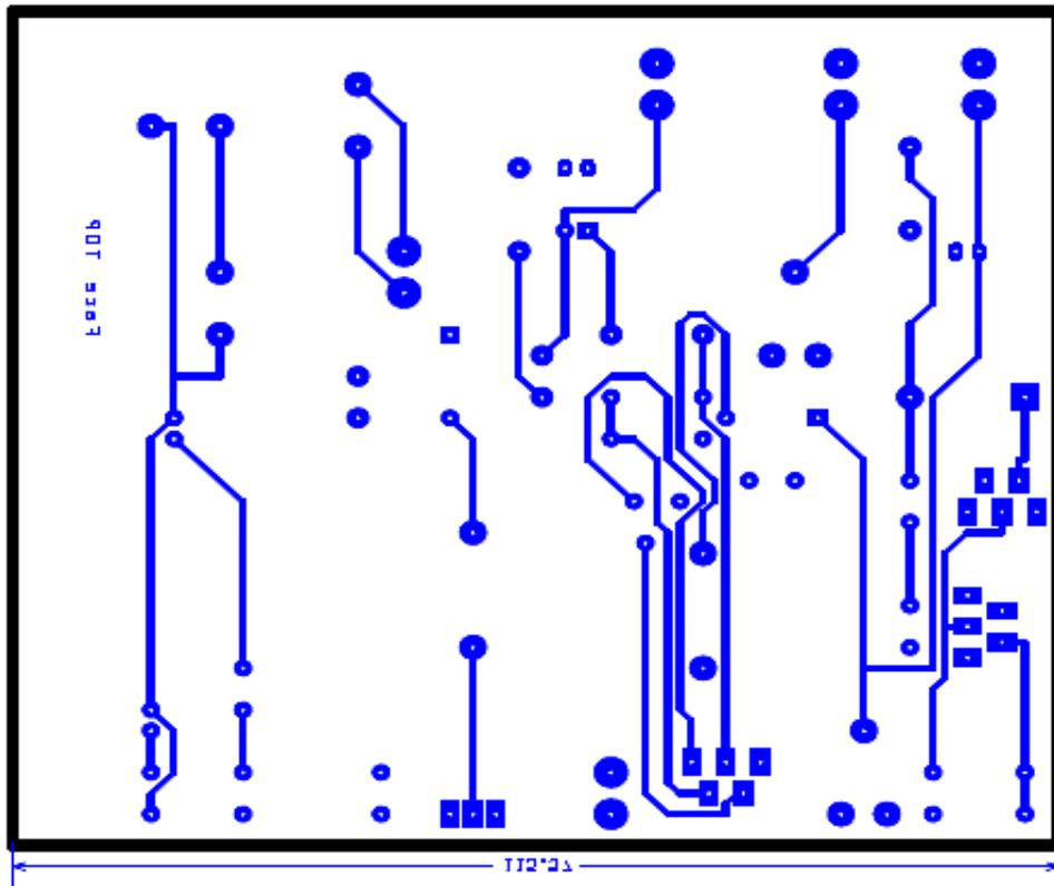
Figure 11 : Typon de la face de dessus(TOP)
