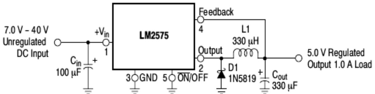
Figure 5: Schéma d'application du régulateur LM2575T-05
