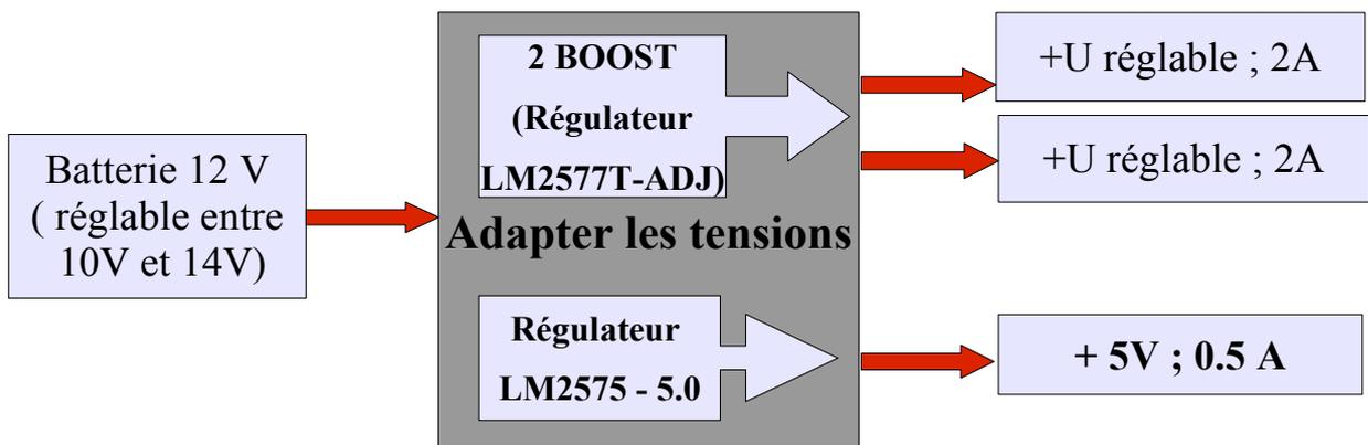
Figure 1 : Sch ma fonctionnel
