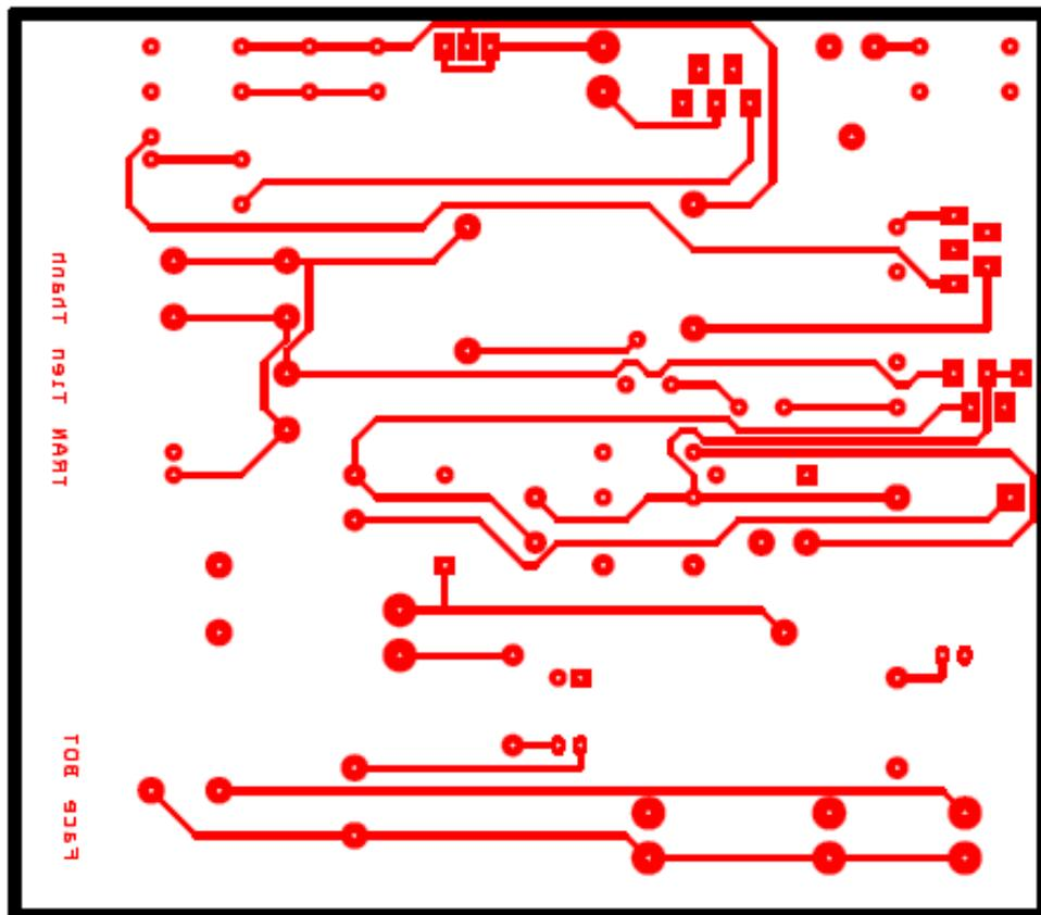
Figure 12 : Typon de la face de-dessous (BOTTOM)
