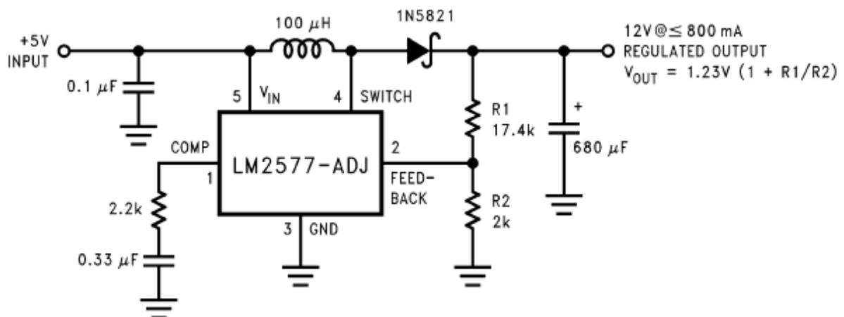
Figure 6 : Schéma d'application du régulateur LM2577T-ADJ
