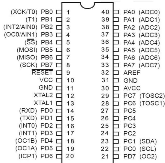
Le microcontrôleur fonctionne avec du 5V continu, qui est relié sur les pattes 10 et 30 et la masse sur les pattes 11 et 31 comme on peut le voir sur la figure ci-contre. Ce composant se programme en langage C, il est branché sur une carte permettant d'accueillir un écran lcd directement relié sur le portC, ainsi que de brancher une carte externe sur le portA grâce à une prise 20 broches (voir figure ci contre).
