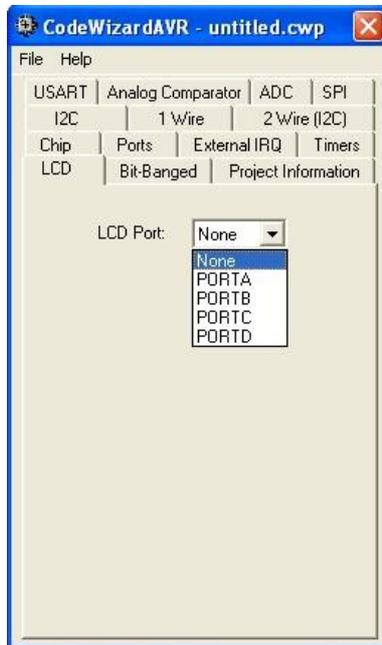
On doit simplement sélectionner le port sur lequel l'écran est relié, et il est configuré.
