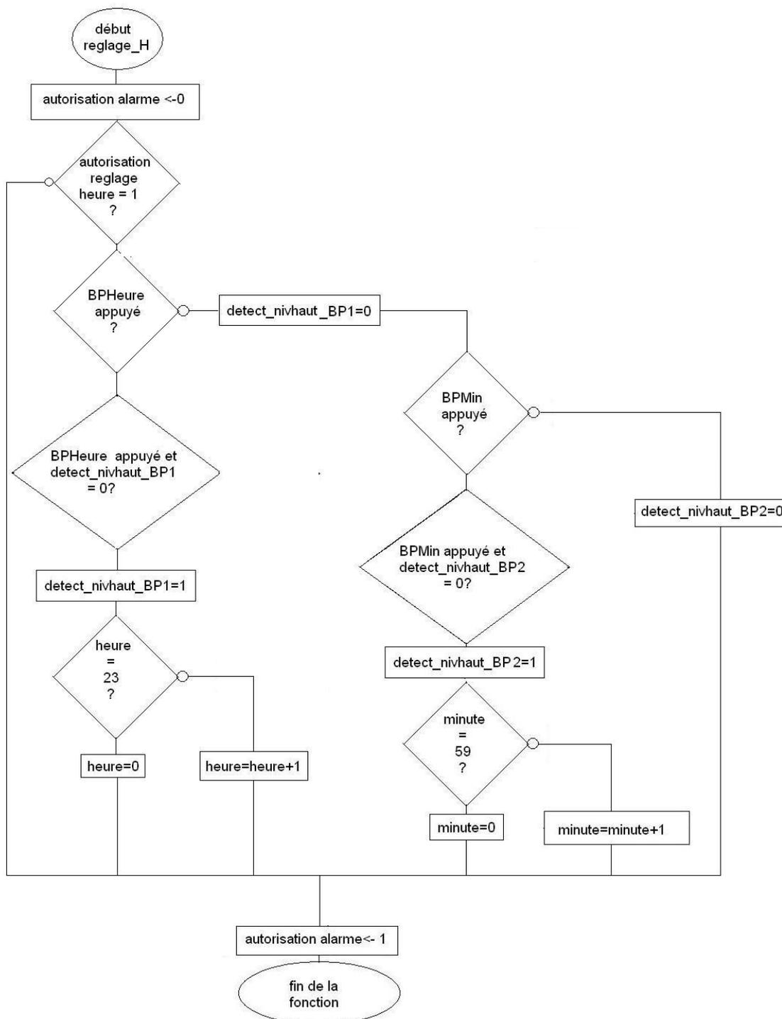
On utilise 2 variables déclarées en entier, qui s'appellent *autorisation\_reglage\_alarme*, et *autorisation\_reglage\_heure*. On met à 0 la variable *autorisation\_reglage\_alarme* et on teste si *autorisation\_reglage\_heure* est à 1, On effectuera la m<sup>e</sup>me démarche dans la fonction *reglage\_A()* en prenant soin d'inverser les variables.
