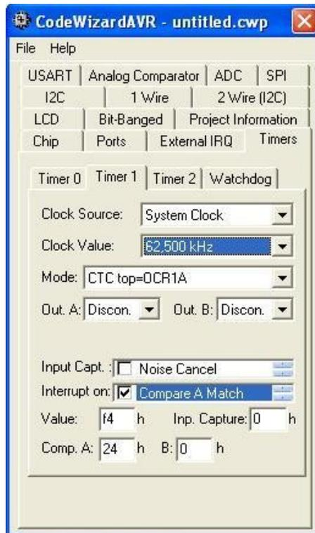
Lors de la fenêtre de configuration initiale, on choisit parmi les onglets: « Timers », qui propose la configuration de 3 timers.
