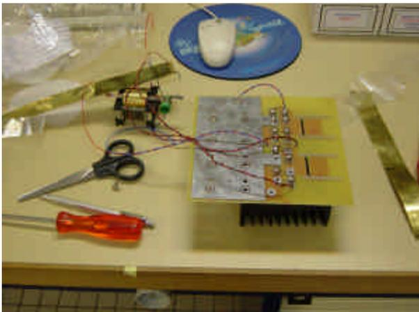
Figure 44: fixation des transistors sur le dissipateur
