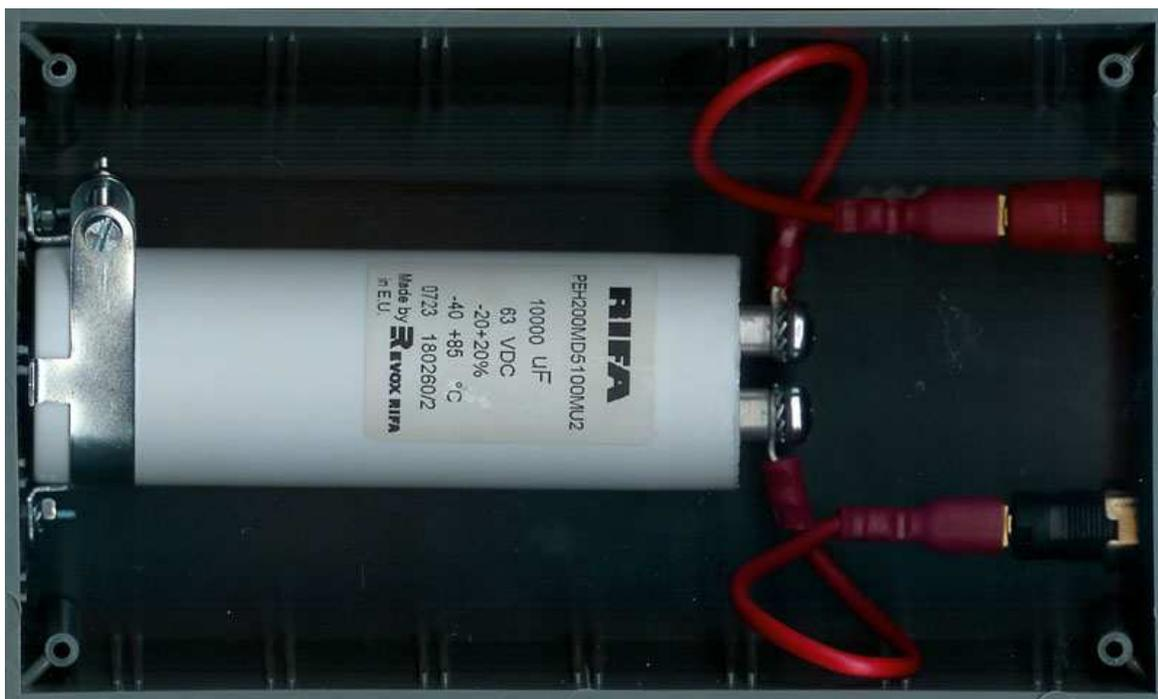
Figure 12.15. Condensateurs de sortie (images-maquettes\capa-10000-uf-2.jpg).
