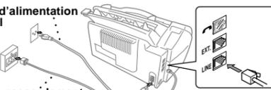
Câble de raccordement au réseau téléphonique
