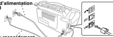
Câble de raccordement au réseau téléphonique
