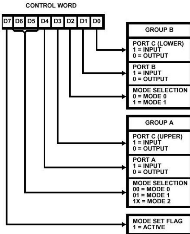
Figure 3.2. Mot de contrôle du 825C55A (images\8255-c.jpg).
