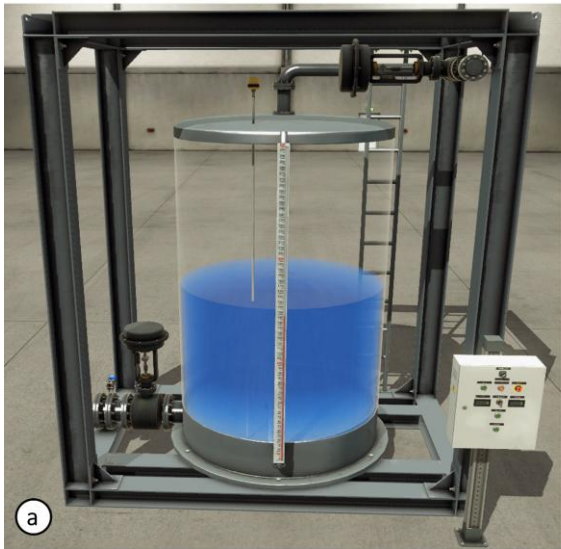
Figure 5 : Jumeau numérique et structure du PID de la régulation
