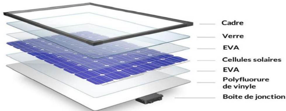
Figure 3 : Composition d'un module photovoltaïque
