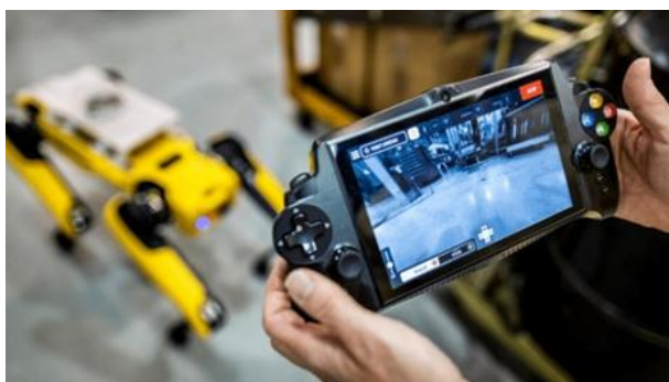
Figure 3 : Pilotage manuel ou Navigation autonome de SpotMini
