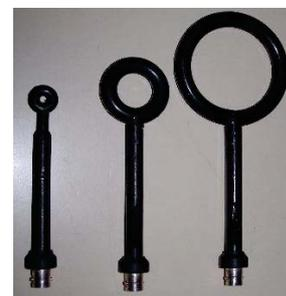
Figure 18 : Antenne de mesure pour champ proche
