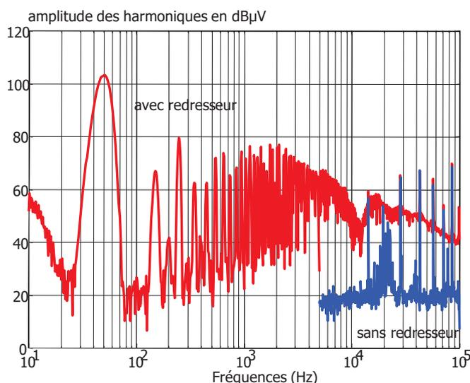
Figure 5 : Effet d'intermodulation dû au redresseur
