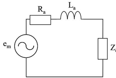
Figure 19 : Modèle équivalent de la sonde de champ
