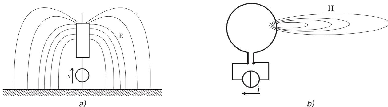
Figure 14 : Émission en champ électrique et magnétique
