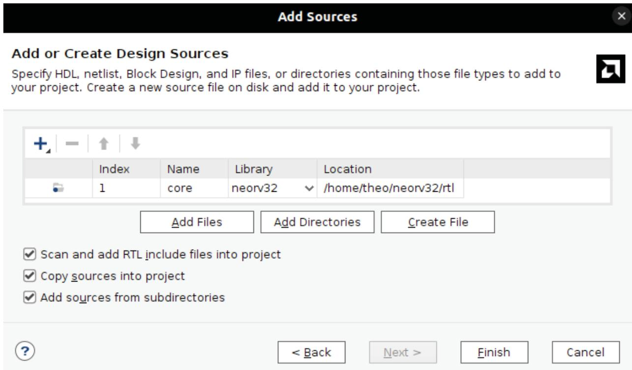
Figure 4 : Capture d'écran de l'importation des sources sur Vivado
