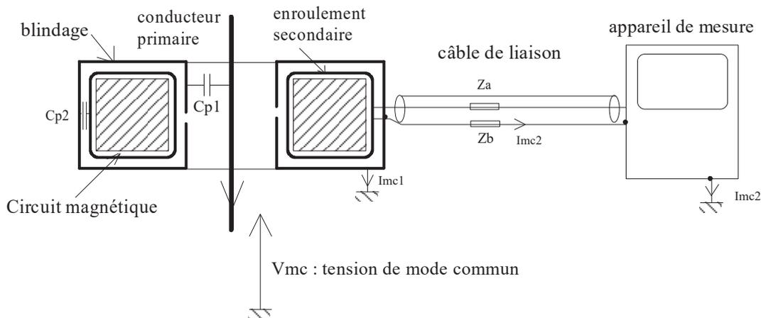
Figure 27 : Réduction des perturbations du capteur par blindage
