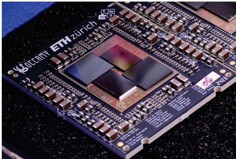
*Figure 2 : Le processeur Occamy, un système sur puce 432+2 cœurs RISC-V, avec une mémoire sur puce HBM2e, une véritable prouesse technologique du groupe PULP, designée en moins d'un an par une dizaine de personnes*
