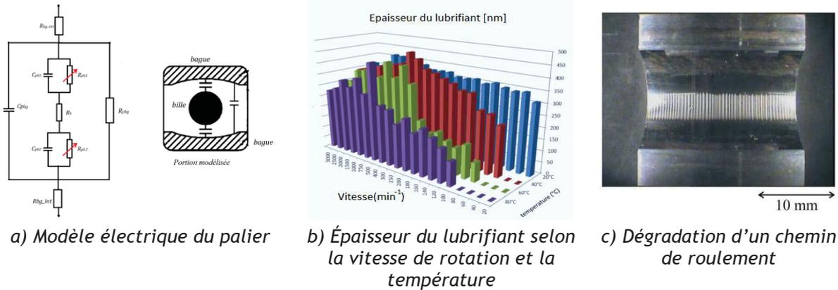
Figure 28 : Comportement mécano-électrique d'un roulement à bille [5], [6]
