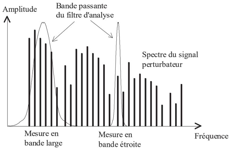
Figure 34 : Signal mesuré en bande étroite ou large
