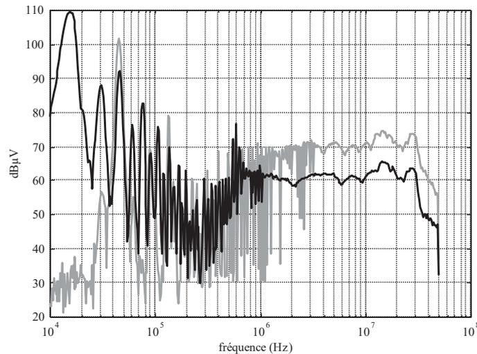
Figure 17 : Conséquence de l'accroissement de fréquence de découpage sur les spectres fréquentiels des perturbations conduites, toutes choses égales par ailleurs. Tracé gris :  $F = 45$  kHz, tracé noir  $F = 15$  kHz
