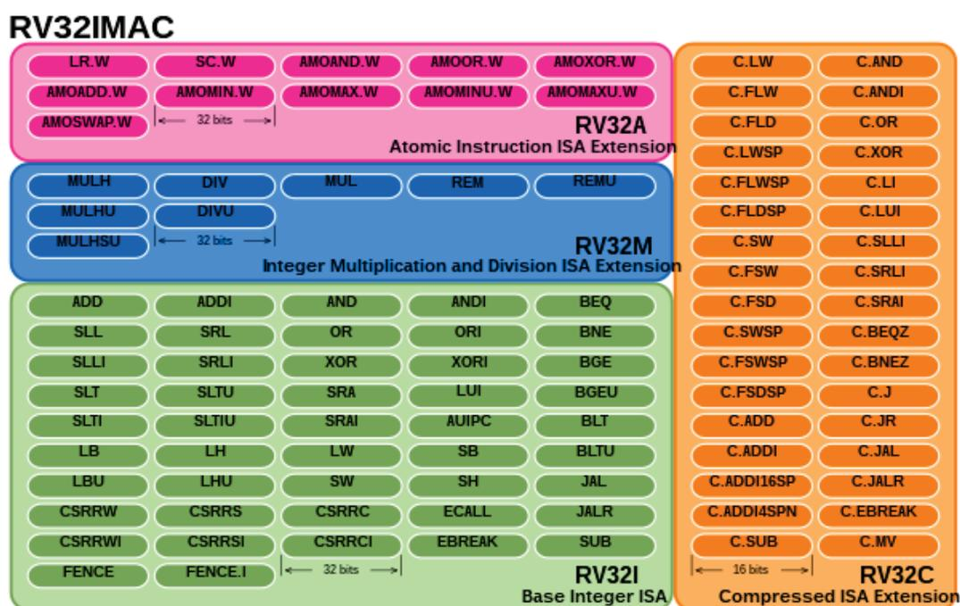
Figure 3 : Instructions supportées par un processeur RV32IMC
