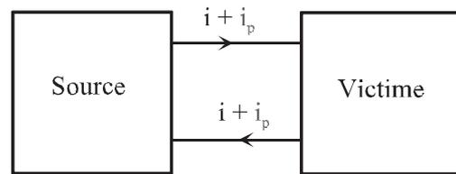
Figure 3 : Circulation du courant de mode différentiel.
