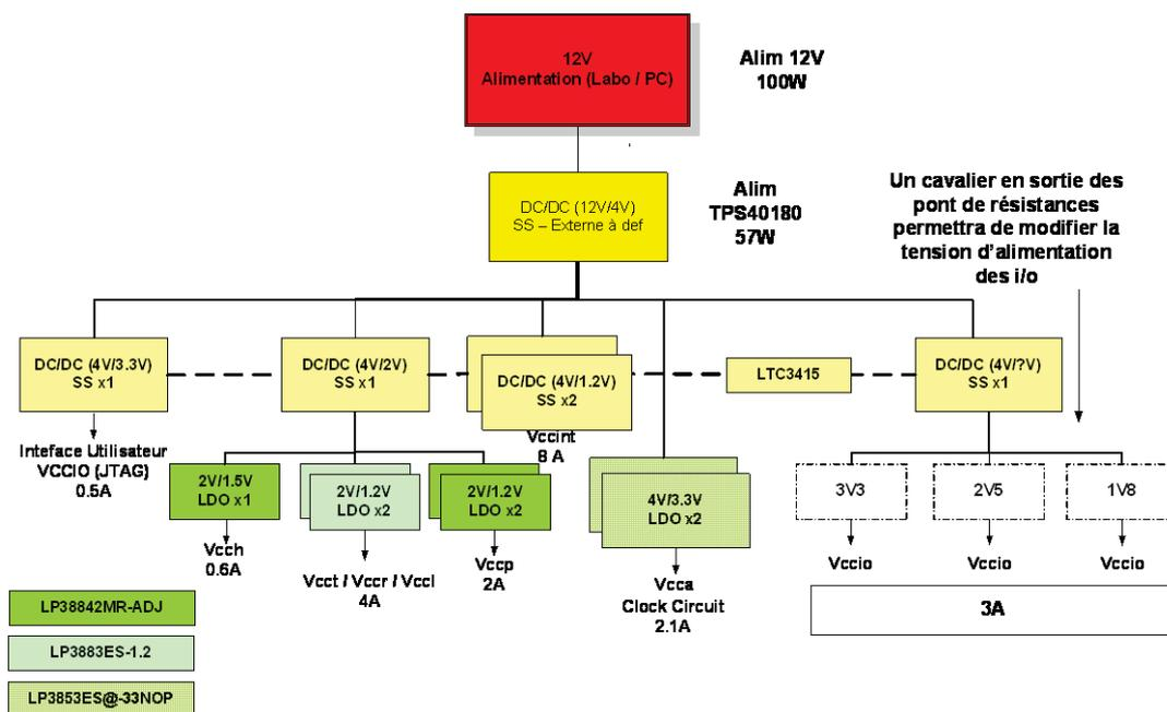
Figure 12 : Exemple de système d'alimentation d'une carte
