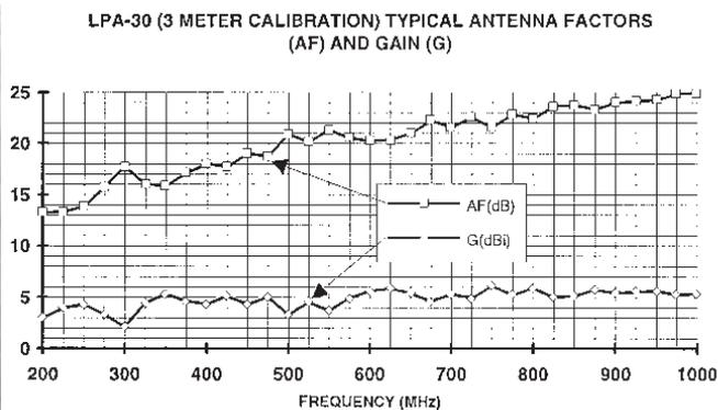
Figure 31 : Antenne log-périodique et son facteur d'antenne (d'après doc. Electro-Metrics)
