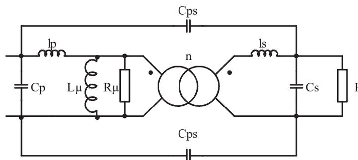
Figure 25 : Modèle du transformateur de courant
