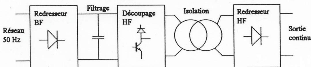
Figure 1 : Structure générique d'une alimentation à découpage
