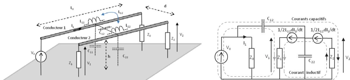
Figure 8 : Effet de diaphonie et modèle circuit équivalent.
