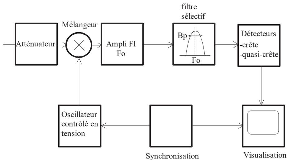
Figure 33 : Structure d'un analyseur de spectre hétérodyne
