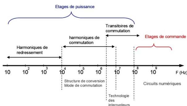
Figure 4 : Étendue fréquentielle des phénomènes perturbatoires
