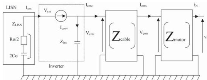
Figure 37 : Modèle équivalent matriciel en mode commun
