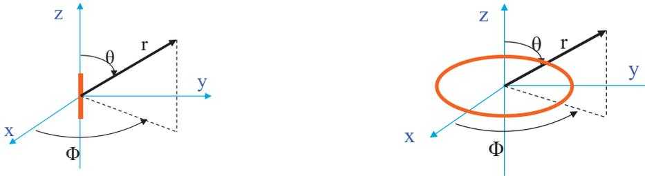
Figure 15 : Représentation des dipôle et boucle élémentaires
