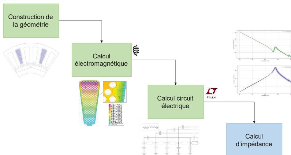
Figure 32 : Flot de calcul pour la modélisation circuit des impédances de modes commun et différentiel d'un enroulement de machine électrique
