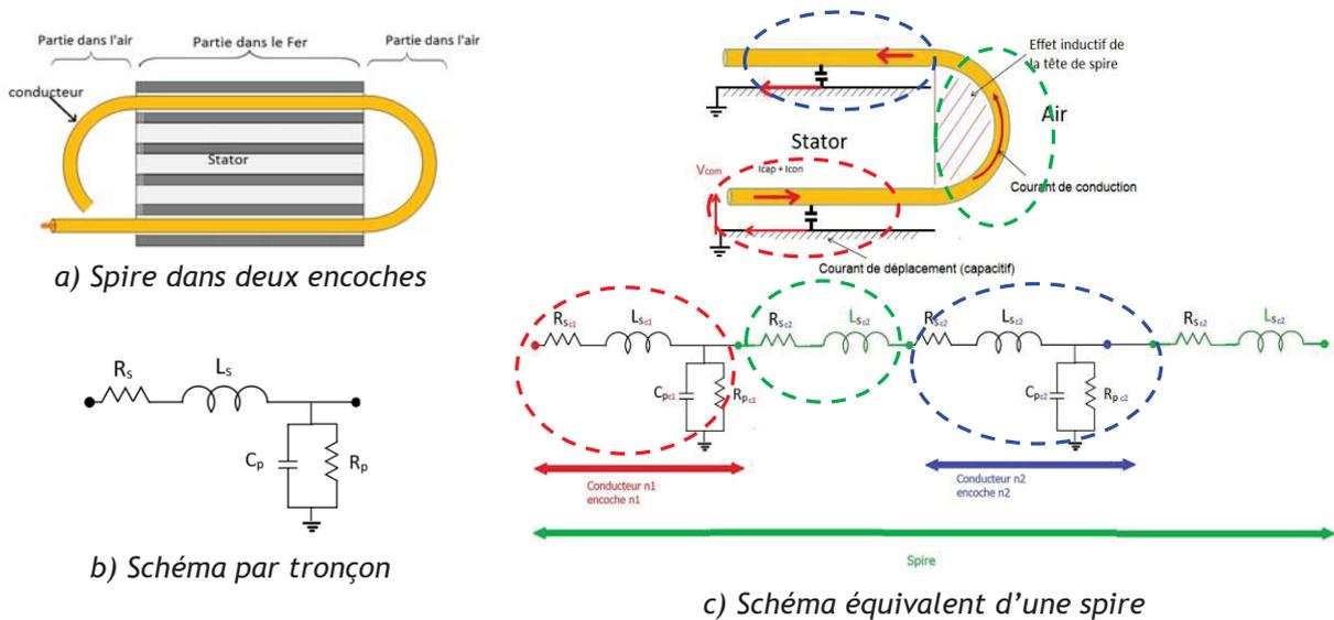
Figure 30 : Schéma électrique d'une spire dans deux encoches
