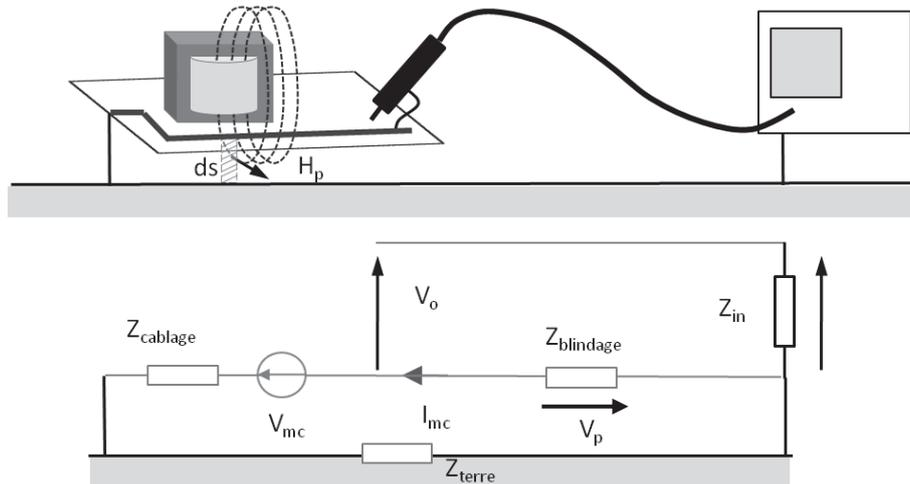
Figure 7 : Couplage champ à câble en mode différentiel
