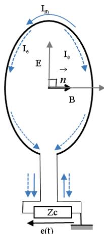
a) Principe de l'antenne boucle
