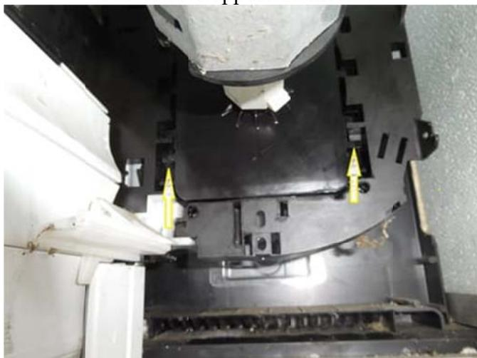
mêmes chose que de l'autre côté avec les ergots noirs (flèches) il faut arriver à ce que l'axe blanc se mette en biais par rapport à la flasque pour qu'il arrive à se dégager vers le haut. Alors on peut retourner côté moteur pour finir de le dégager .
